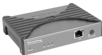
Рис. 2.4. Устройство стандарта HomePlug
